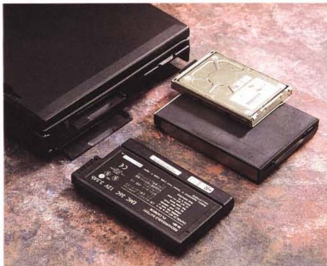
Sulla sinistra l'alloggiamento della batteria, uno slot PCMCIA, l'HD da 2,1 GB e il floppy sostituibile con la seconda batteria.
